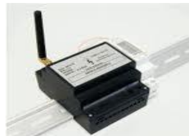
Foto: voorbeeld datalogger met puls-ingangen.
